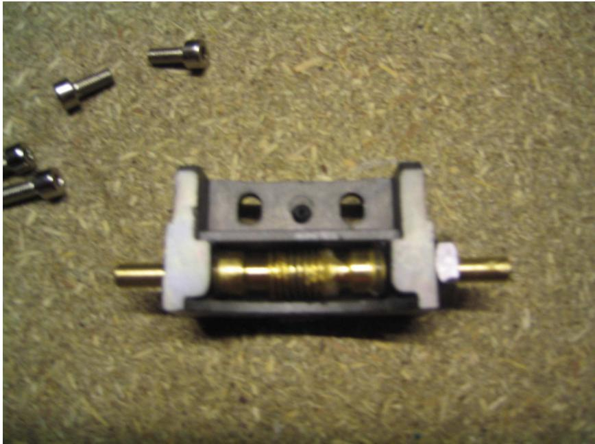
Dévisser la vis à l'aide d'une pince et retiré là en prenant soin aux joints toriques et aux rondelles laiton et PVC a chaque extrémité.
