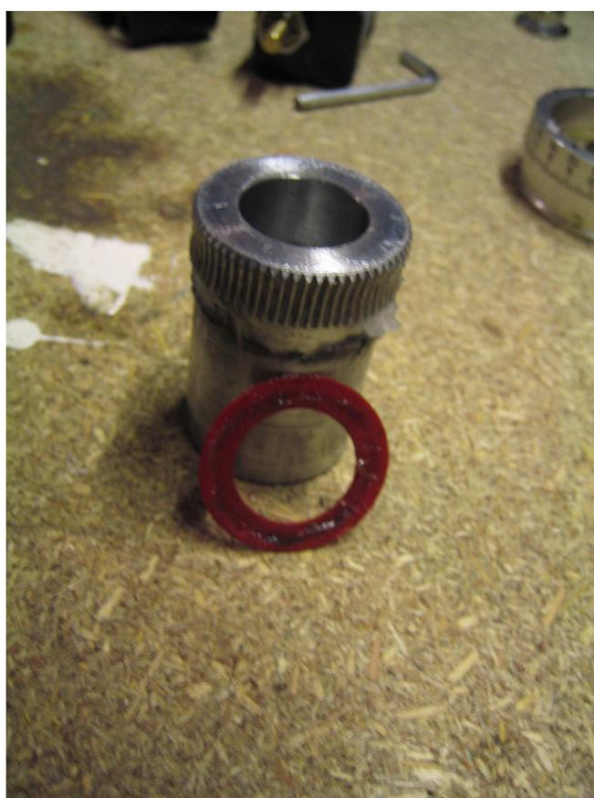
On enlève les deux joints au fond, et la plaque sur le coté et la pastille en laiton (plaque sur laquelle est exercé la pression de la vis de blocage). Et on devise également la vis de blocage.
