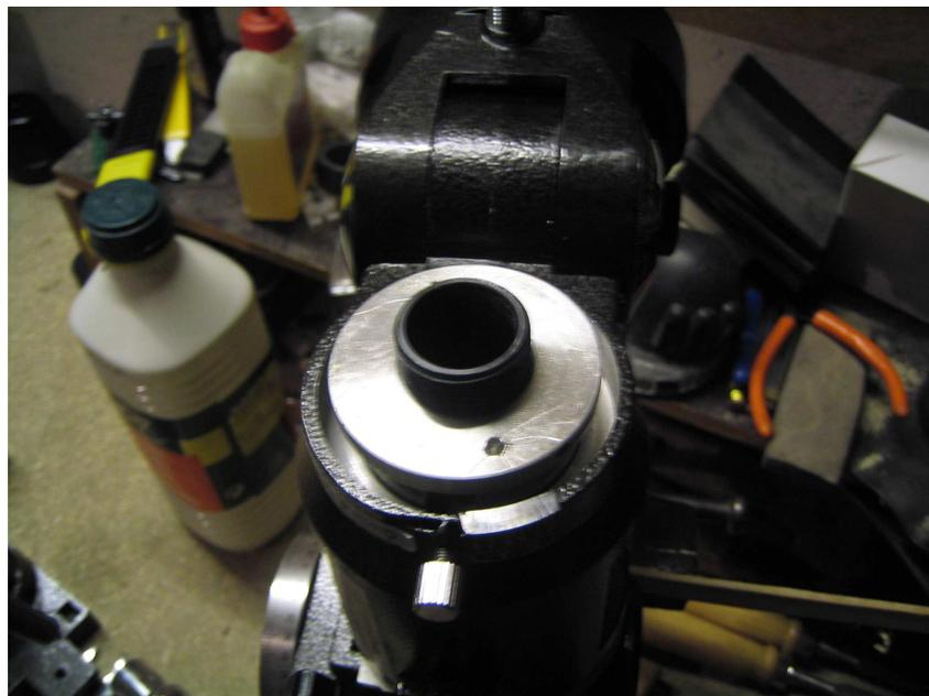
La solution pour moi a été de prendre un pointeau et de taper petit a petit avec un marteau pour débloquer la rondelle-écrou. La difficulté est de trouver le bon angle du pointeau pour avoir assez de force sur la rondelle et pour éviter de ripper dessus Ma solution n'est pas la plus élégante, mais on fait avec les moyens du bord !! ☺
