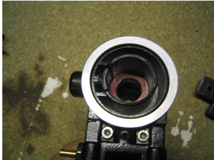
Démonter la vis sans fin de l'axe d'ascension de la même manière que pour l'axe déclinaison (clé Allen) et la mettre de côté avec celle de déclinaison.
