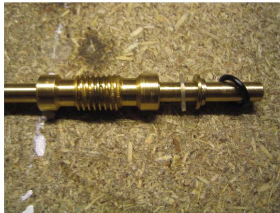
Maintenant nettoyé soigneusement tout ça toujours à l'essence F et pulvérisé de la graisse dans la cage, sur les rondelles, sur la vis, enfin partout !!
